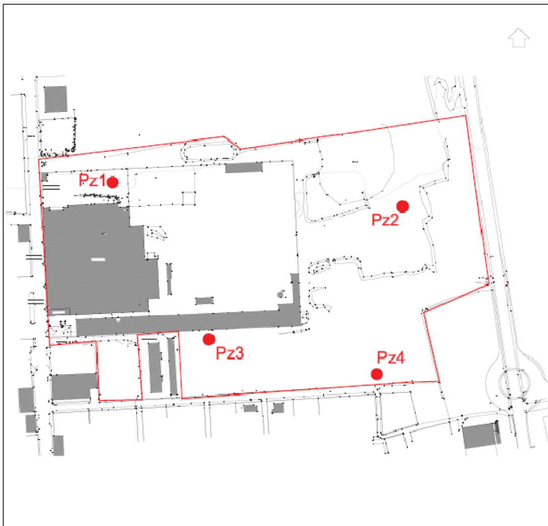
Fig. n.2 – Ubicazione piezometri di monitoraggio
